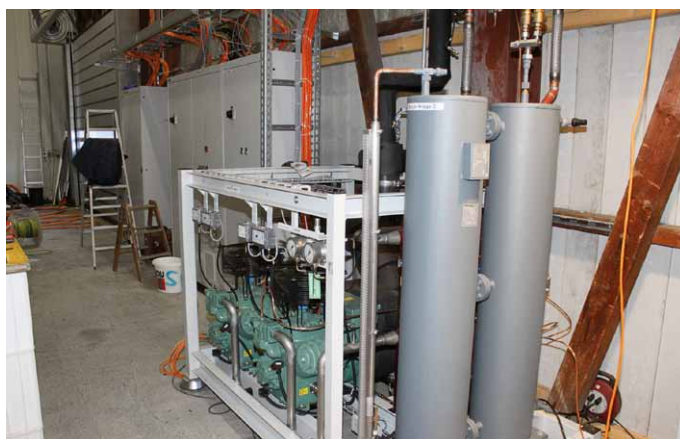
Eine Tiefkühl-Schockanlage steht versandbereit im Lager.
